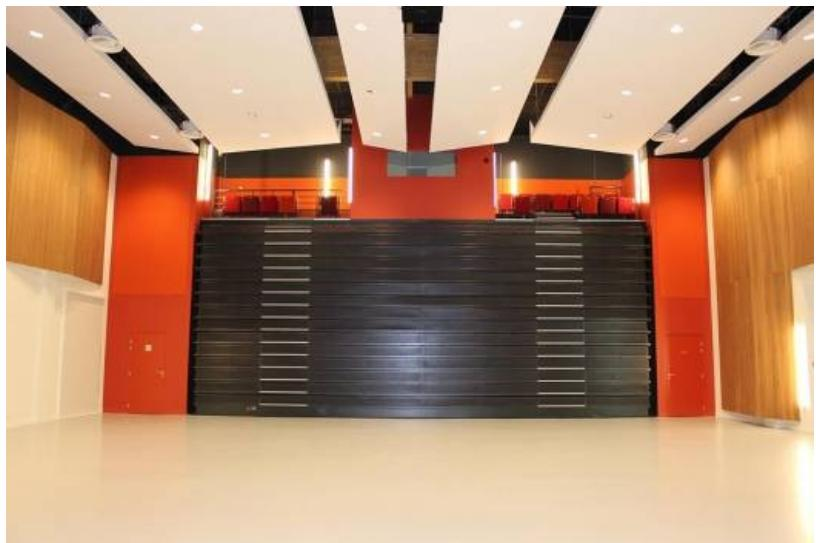
La tribune rétractable est constituée de 15 rangées de sièges qui se replient sous le plancher du premier étage supportant la régie technique où est piloté le matériel scénique (son, lumières, vidéo).
